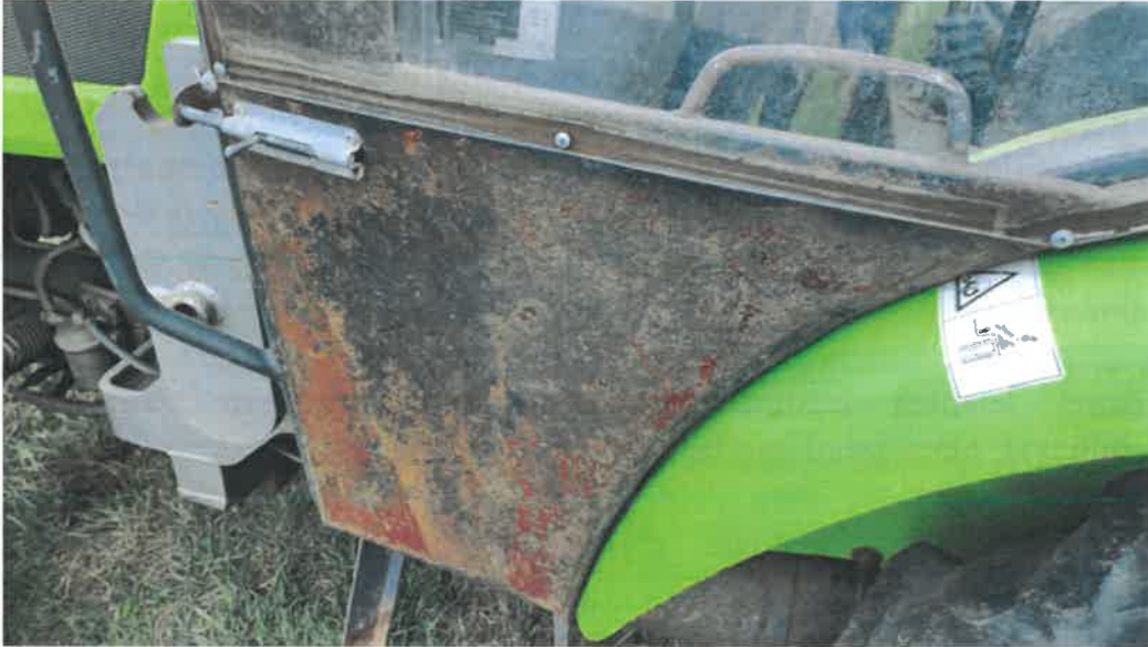
2. sz. kép: Provizórikus karosszéria javítások
